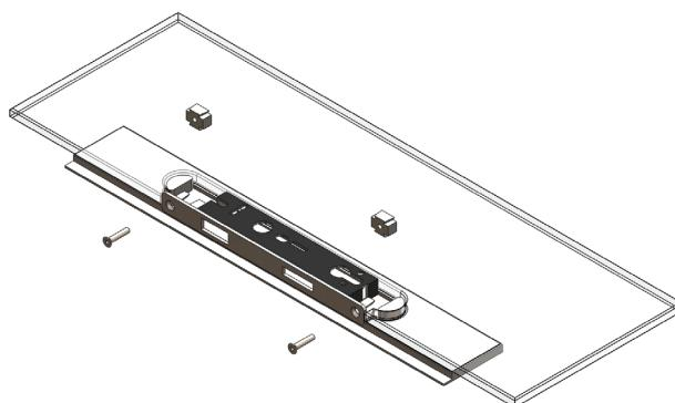
**schritt 7** legen Sie nun das zweite tuerschild passgenau von oben auf die glasflaeche (achtung: pvc unterlagen nicht vergessen). auch hier muss der stulp sehr praezise in den abgerundeten stirnseitigen aufnahmerand des tuerschildes passen.
