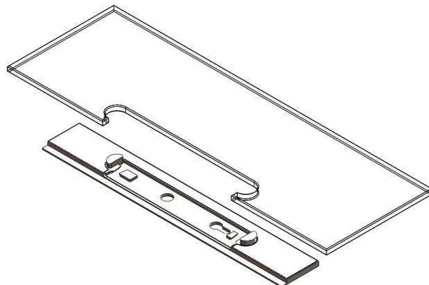
**schritt 5** legen Sie nun das einsteckschloss von oben in den glasausschnitt im tuerblatt so ein, dass das stulpblech genau in den abgerundeten stirnseitigen aufnahmerahmen des tuerschildes passt.
