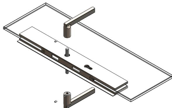
**schritt 10** edelstahloberflaechen sind empfindlich. gehen Sie mit sorgfalt vor. reinigen Sie die oberflaechen im anschluss an die montagearbeit mit edelstahl-pflegespray.
