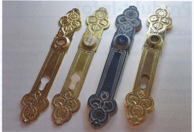
Der Weg vom Zimmertürschild zum fertig gegossenem Sicherheitsschild im 3D-Druck (von links nach rechts) (Bild: Antike Beschläge Schierding).
